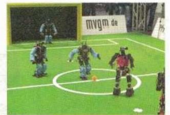
Die Roboter kommunizieren per WLAN und haben 21 Motoren und eine Kamera auf dem Kopf. So können sie laufen und dribbeln, so spielen sie den Ball und schießen Tore.
